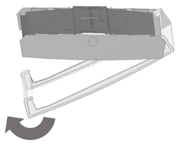
4) MAKE SURE BOTH SIDES OF THE LENS ARE FULLY ENGAGED IN THE CHANNEL BY GENTLY SLIDING THE LENS BACK AND FORTH LATERALLY TO ENSURE THE LENS IS FULLY SEATED ALONG ITS ENTIRE LENGTH.
