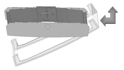
2) HOOK ONE SIDE OF THE LENS ON THE CHANNEL FLANGE.
